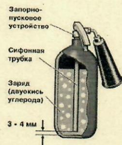
ПРИНЦИП ДЕЙСТВИЯ основан на вытеснении двуокиси углерода избыточным давлением. При открывании запорного ручного устройства CO<sub>2</sub>, по сифонной трубке поступает к раструбу и из сжиженного состояния переходит в твердое (снегообразное). Температура резко (до -70 °C) понижается. Снегообразная масса, попадая на горячее вещество, изолирует его от кислорода
